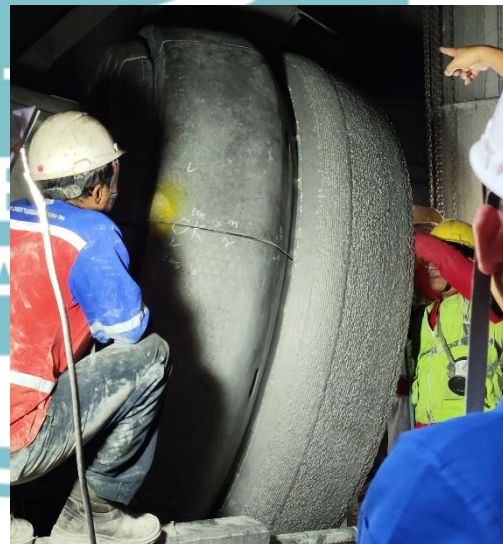
Lampiran 3 Inspeksi visual permukaan tire grinding roller
