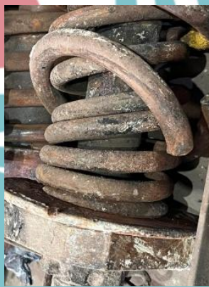
Gambar 1. 1 Kondisi Kerusakan Pegas Boffer Sumber: Dokumen Pribadi
