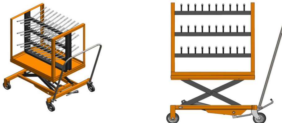
Gambar 4 Hasil Desain 3D Hydraulic Lift Trolley (Sumber : Gambar Dibuat Oleh Penulis)
