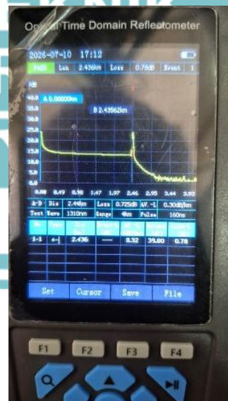
Tampilan trace OTDR jalur ONT Bridge Smartlab sebagai pembanding jalur aktif.
