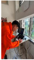
Pelaksanaan pengujian QoS pada sisi ONT menggunakan laptop penguji.
