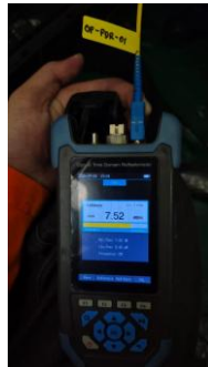
Pengukuran daya keluaran port PON OLT pada panjang gelombang 1490 nm.
