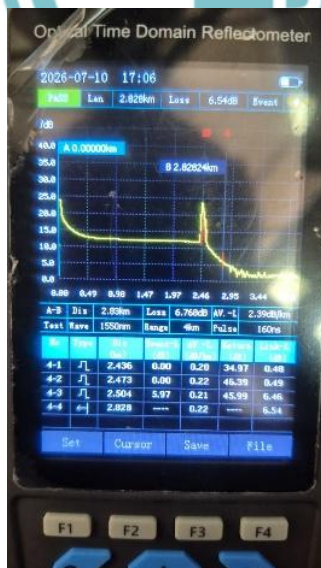
Tampilan trace OTDR jalur ONT Lantai 1 pada panjang gelombang 1550 nm.
