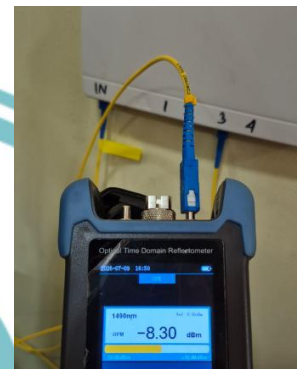
Pengukuran daya optik pada titik akhir jalur ONT Bridge Smartlab .
