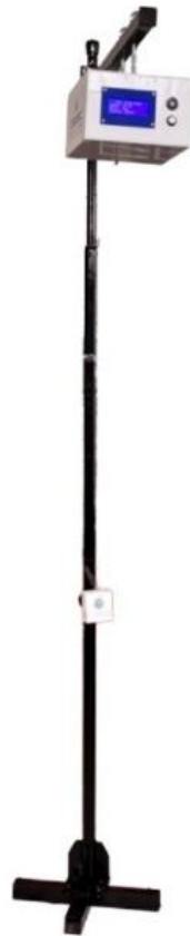
Gambar 3.15 Realisasi Alat Pendeteksi Jatuh Nirsentuh
