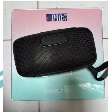
Gambar 4.12 Hasil pengujian dengan timbangan referensi
