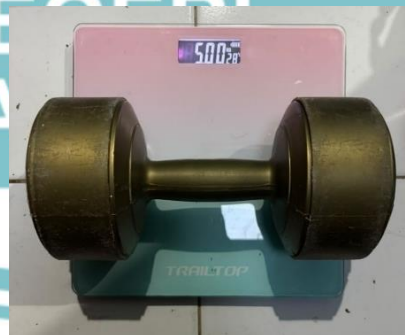
Gambar 4.14 Hasil pengujian timbangan referensi dengan bobot sedang
