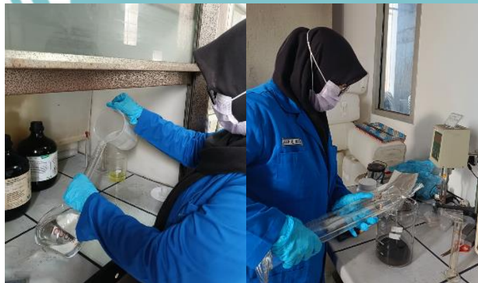
Lampiran 3 Proses Pre-Treatment HCl Karbon CKS menggunakan HCl 2M selama 6 jam pada suhu 60°C dan putaran 500 rpm
