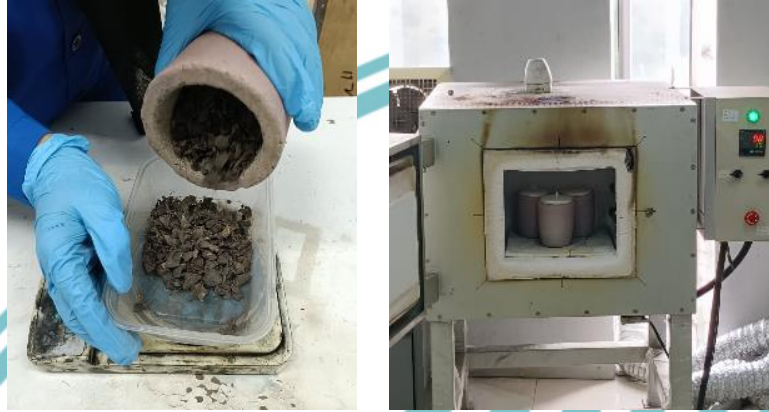
Lampiran 1 Proses Karbonisasi Cangkang Kelapa Sawit dengan Suhu 400°C
