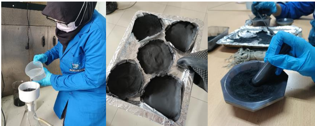
Lampiran 4 Proses Filtrasi setelah Pre-Treatment HCl dibiarkan overnight hingga pH netral menggunakan aquades kemudian dioven dan dihaluskan.
