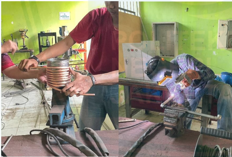
Lampiran 3 Kegiatan Fabrikasi Roll pipa dan Pengelasan Pipa
