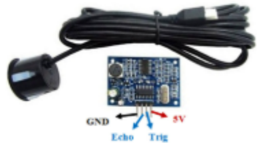
Susunan Pin JSN SR-04T
