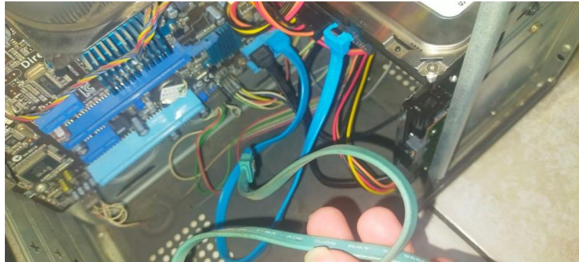
Temuan Kendala Teknis Kerusakan Fisik pada Kabel Data SATA saat Implementasi Perangkat Keras Server.
