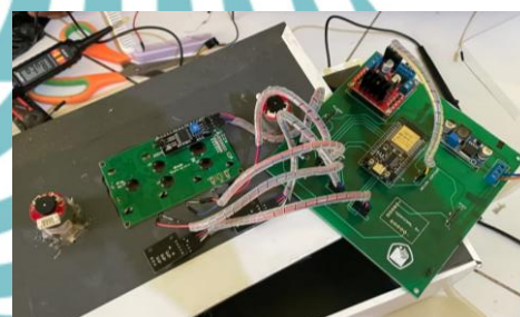
Pemasangan seluruh komponen ke trainer kit
