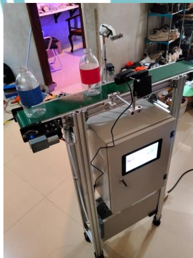
Prototype Sistem Pengisian Botol Otomatis dengan Kontrol Adaptif Berbasis YOLOv8
