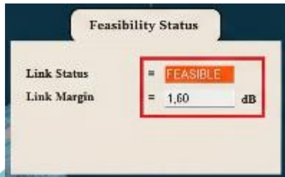
Gambar 4. 33 Hasil Status Kelayakan Tautan Kondisi Warning pada Aplikasi.
