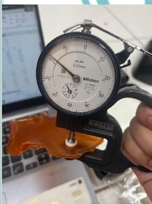
Ketebalan Film diukur Menggunakan Thickness Gauge
