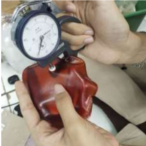
Proses Uji Ketebalan Menggunakan Thickness Gauge
