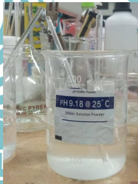
Kalibrasi pH meter dengan buffer
