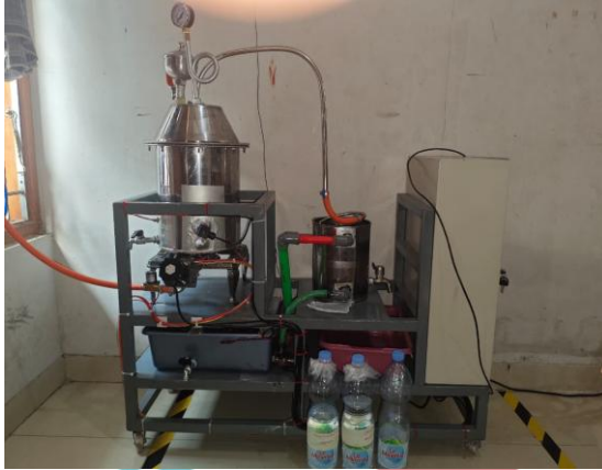
Alat Distilasi Metanol-Air
