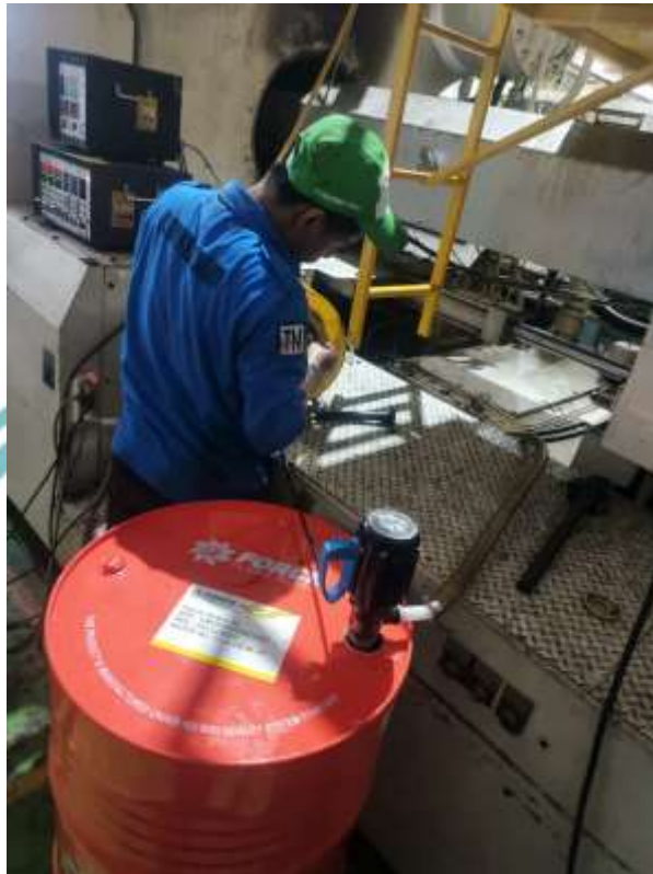
Proses Pengisian Oli 200 Liter pada mesin Toshiba 1300 TON
