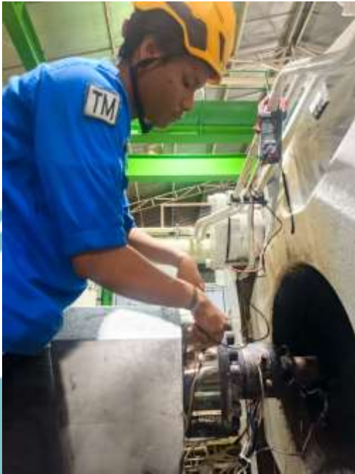
Proses pengecekan pada heater menggunakan Avo Meter
