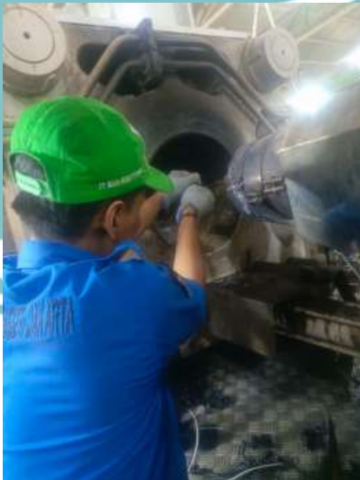
Proses pengecekan pada heater menggunakan Avo Meter
