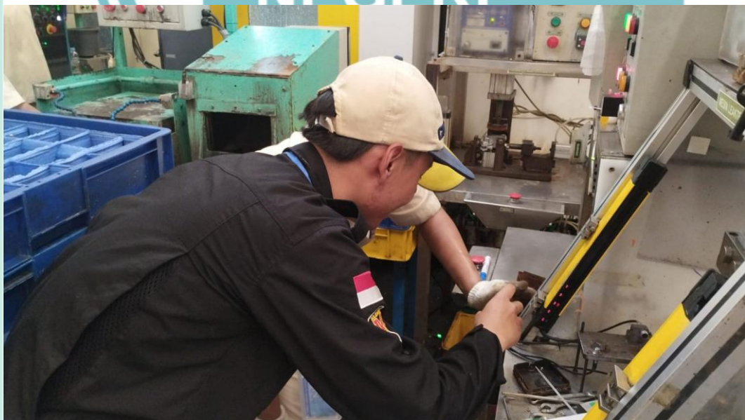
Lampiran 14 Memperbaiki Tombol ON pada Mesin Leak Test
