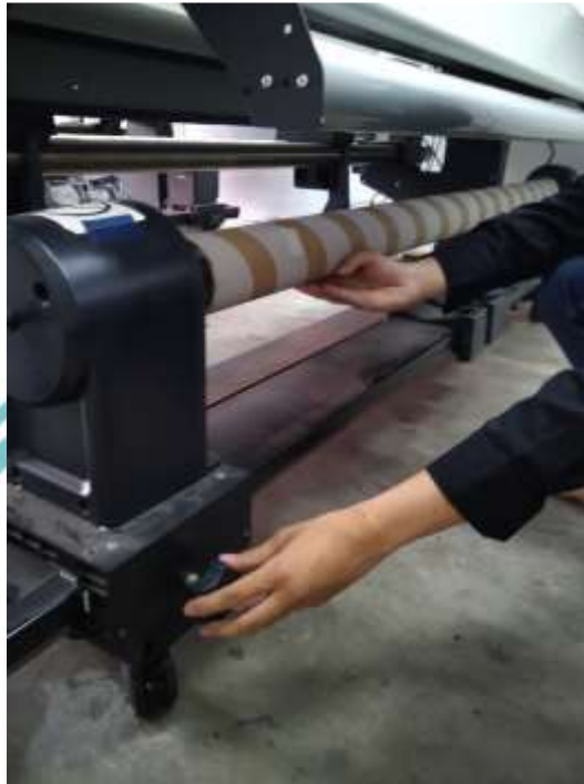
Gambar 3.17 Memasang core pada feed tempat selesai diprint
