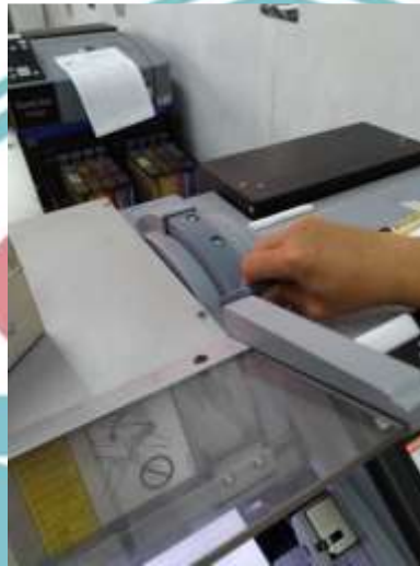
Gambar 3.15 Menurunkan lock media lever
