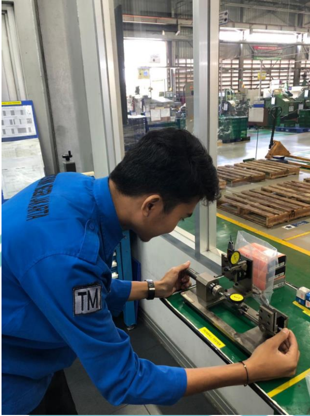
Gambar 5. 3 Cek dimensi produk menggunakan pickball tester untuk concentricity
