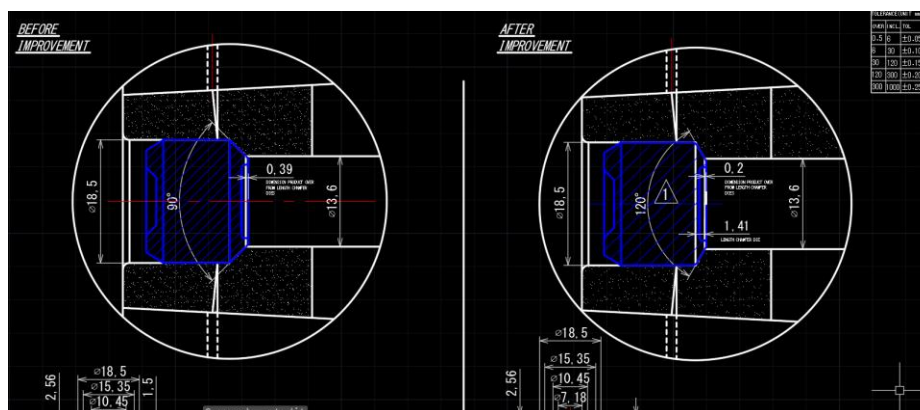
Gambar 1. 1 Contoh besar sudut yang tidak sesuai standar
