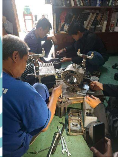
pergantian bearing pada kompressor cadangan mesin Komori
