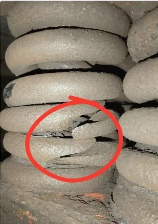
Gambar 46 Dokumentasi Spring patah
