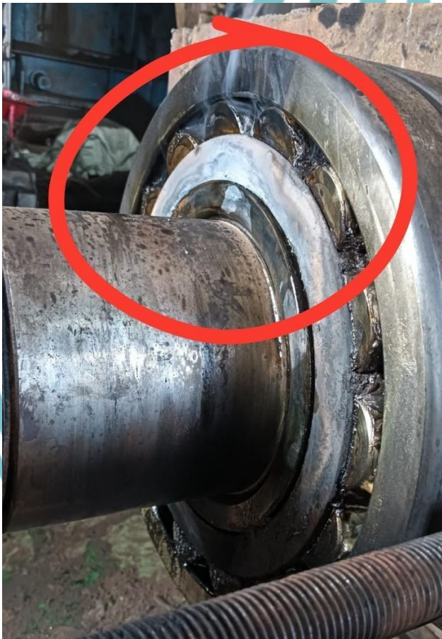
Gambar 45 Dokumentasi Kerusakan Bearing
