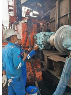
Gambar 13 Pengukuran Vibrasi Motor Boom STRE
