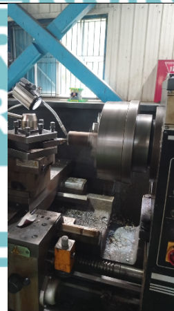
Gambar 5.18 Membubut Ulir Pipa & Elbow Besi
