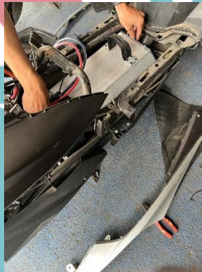
Gambar L. 4 Pemasangan Baterai Baru pada Motor Listrik
