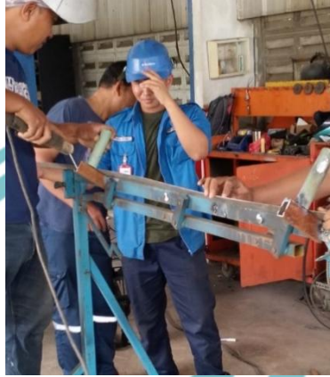
Gambar 1 Pembuatan Rak Troli Chasis Motor Gesits
