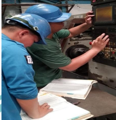
Gambar 3 Penetapan Parameter Mesin CNC 11
