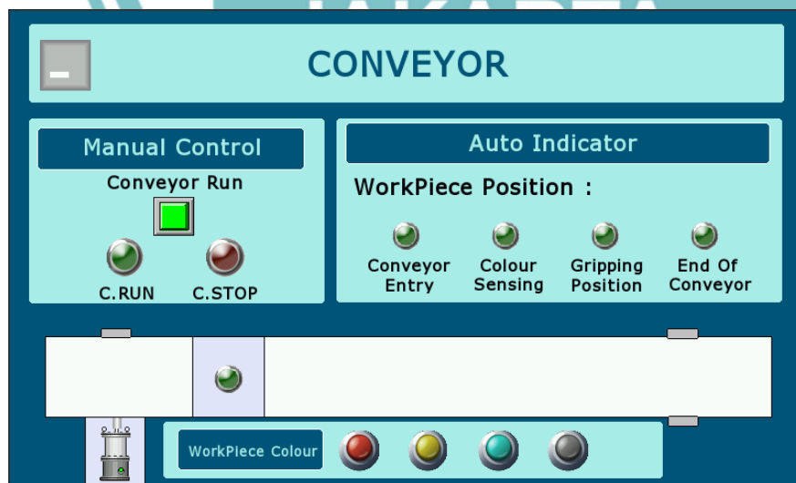
Gambar 8 Tampilan HMI slide modul konveyor
