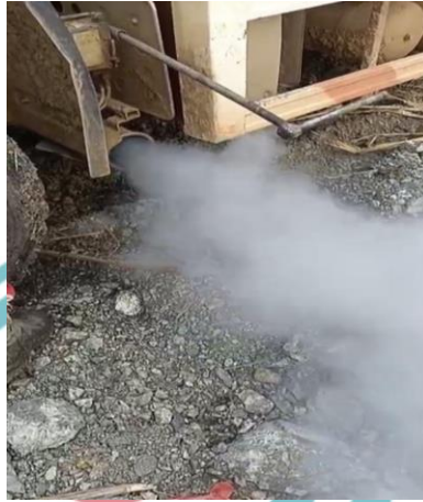
Lampiran 1 Fenomena white smoke pada unit dump truck
