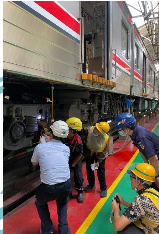
Lampiran 6 Minggu ke-6 Evaluasi uji coba pengadaan remblock oleh JRTM Japan
