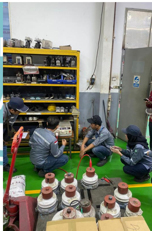
Lampiran 8 Minggu ke-8 pengujian komponen arester INKA
