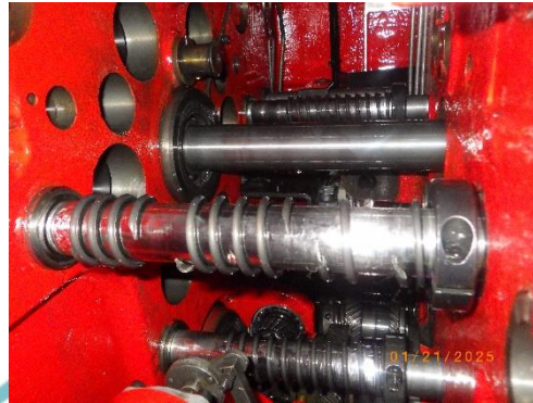
Gambar 1.1 Lokasi Terjadinya Patah Return Spring
