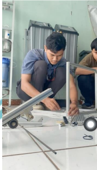
Lampiran 5 Pemasangan Gantry V-Wheel Sumbu Y dan Rel Sumbu X
