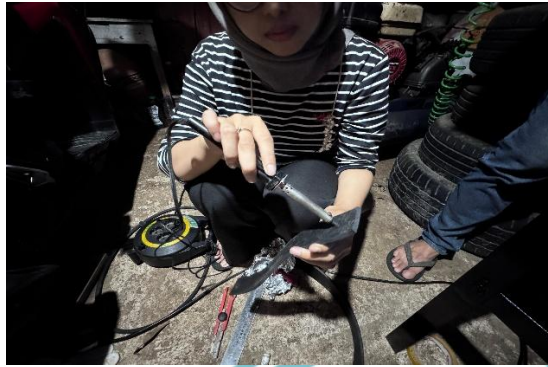
Pembolongan material dengan solder
