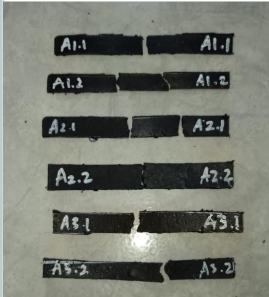
Lampiran 2. Hasil Patahan Uji Kuat Lentur
