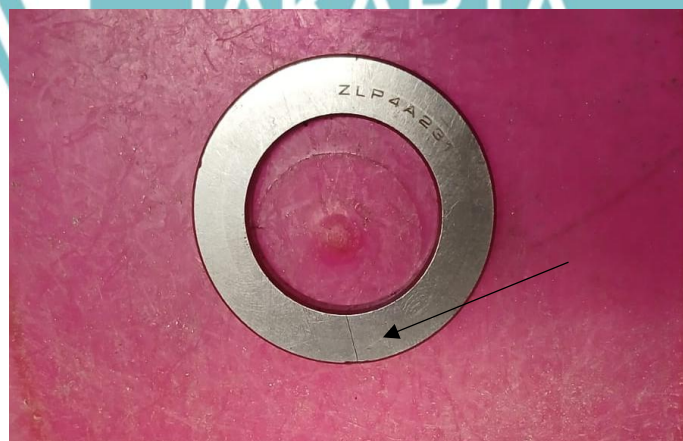
Gambar 1. 1 Kerusakan Bearing tipe ZLP4A231
