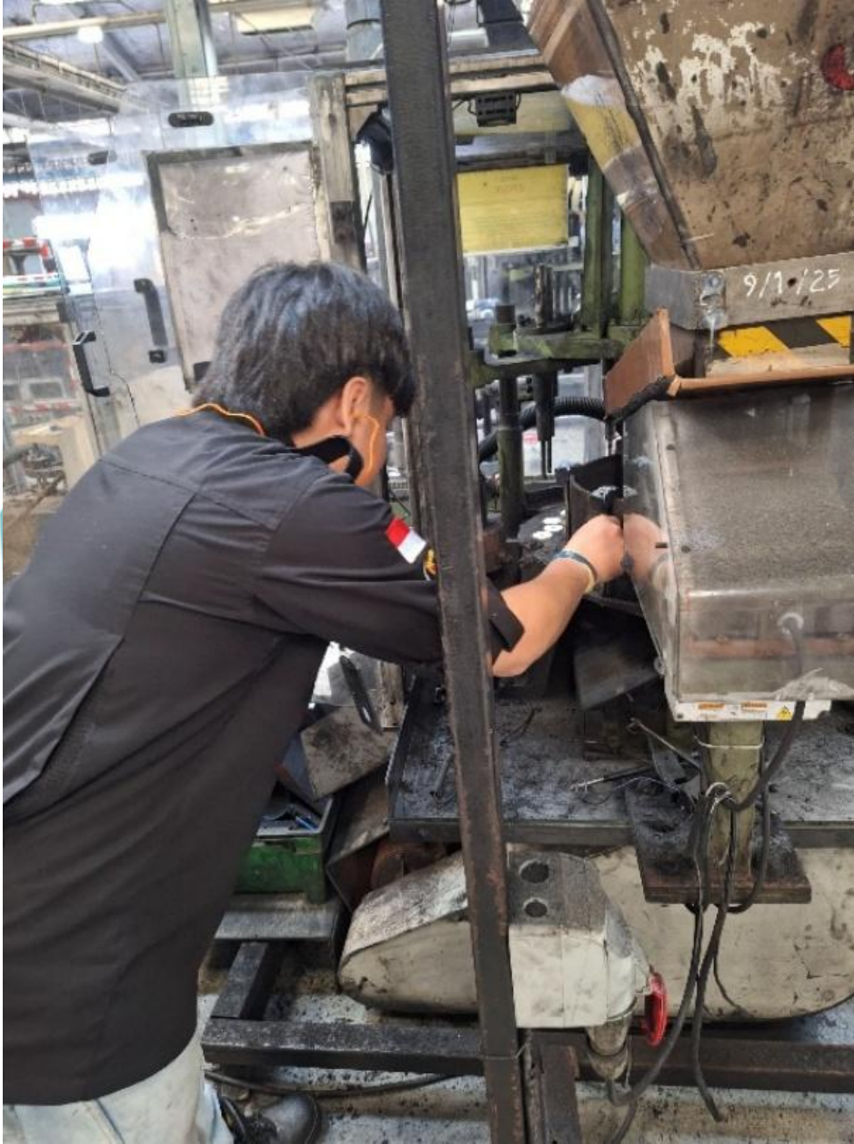
Gambaran Lampiran 2. Membersihkan Mesin Mix Filling dari Kontaminasi Carbon Mix
