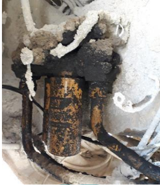
Lampiran 5 Filter transmisi oli sangat hitam
