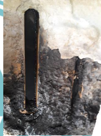
Lampiran 2 Oli transmisi sangat hitam & level oli terlalu tinggi
