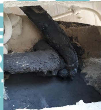
Lampiran 4 Saluran suplai transmisi kotor & oli sangat hitam
