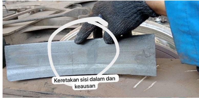
Gambar 1.2 Keretakan sisi dalam dan keausan (Sumber:Dokumentasi Pribadi, 2025)
