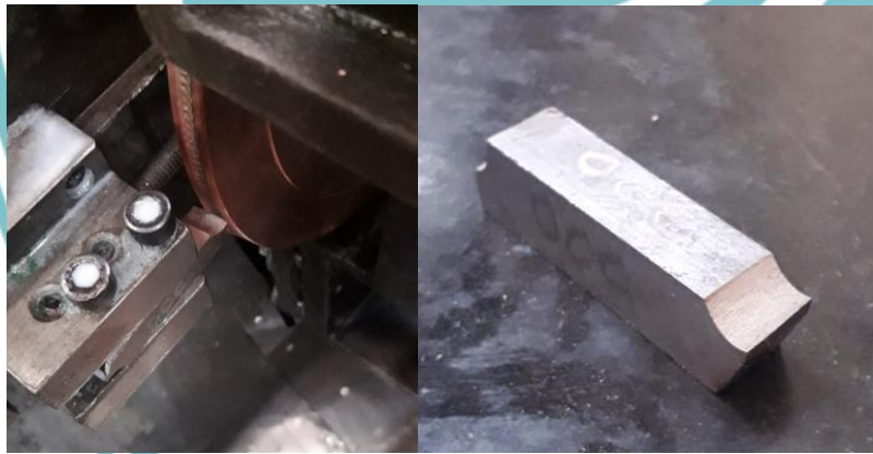
Posisi Pahat Elektroda ketika terpasang
