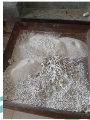
7. Pengujian Kadar Lumpur Agregat Kasar Batu Pecah
