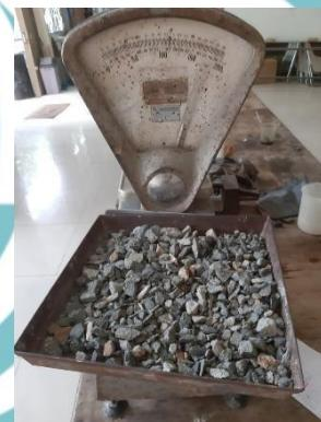
8. Pengujian Kadar Lumpur Agregat Halus Abu Batu
