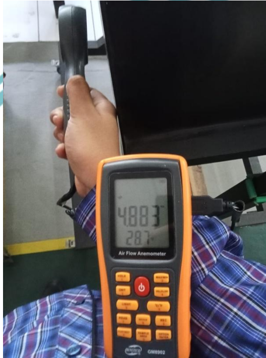
Pengambilan Data Kecepatan Angin di depan Turbin Angin
