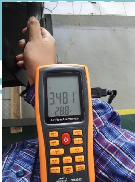
Pengambilan Data Kecepatan Angin di belakang Turbin Angin
