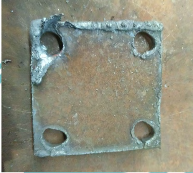
Hasil pemotongan yang tidak presisi oleh mesin CNC plasma cutting
