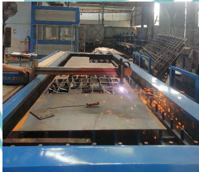
Proses pemotongan plat tebal 8 mm
