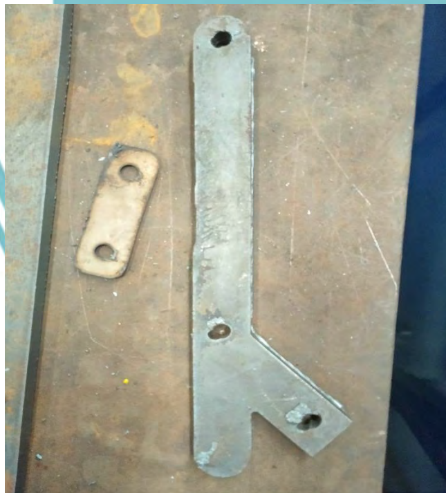
Hasil pemotongan yang tidak presisi plat tebal 10 mm
