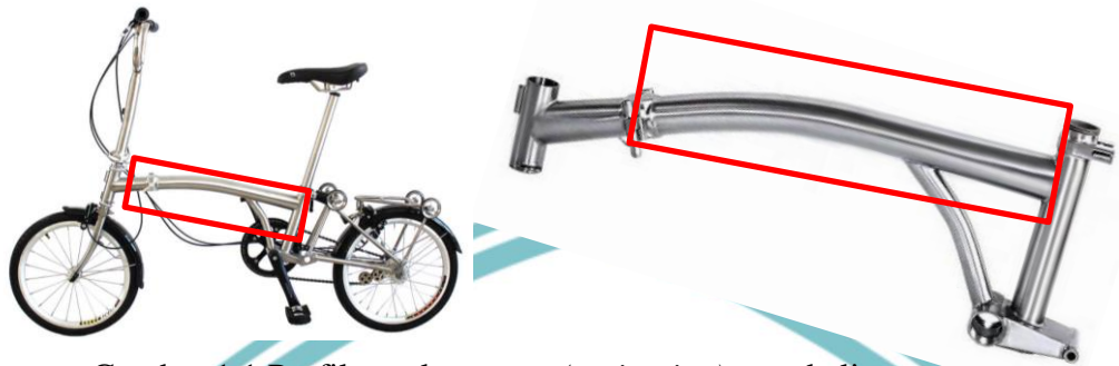
Gambar 1.1 Profil rangka utama ( main pipe ) sepeda lipat
