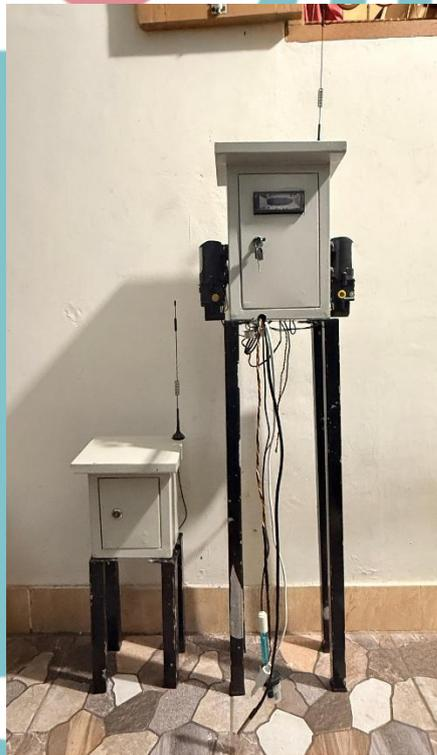
Gambar 3. 6 Visualisasi alat *transmitter* dan *receiver*
