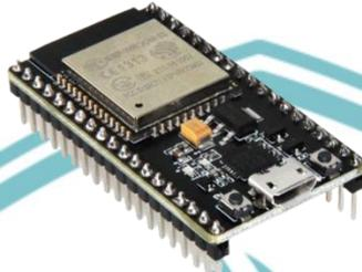
Gambar 2. 3 Mikrokontroler ESP32
