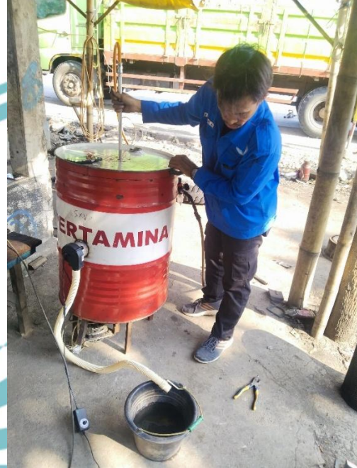
Mengoperasikan alat dengan menaik-turunkan pipa nozzle
