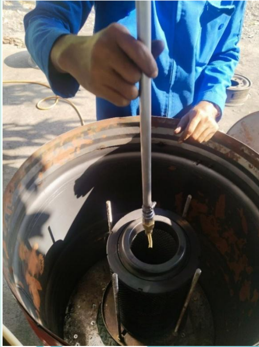
Memasukkan filter udara dan pipa nozzle
