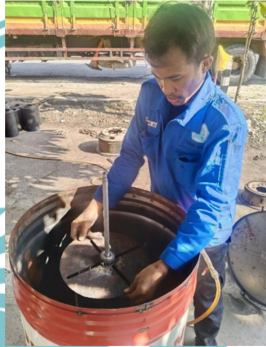
Memasang pengunci filter
