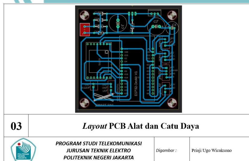
L- 14 Layout PCB Catu Daya Dan Perlintasan
