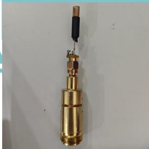
Gambar 4. 2 Antena LoRa yang tersambung konektor LoRa
