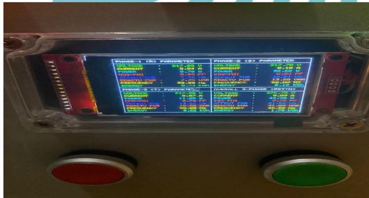
Gambar 2.7 TFT LCD 2.4” SPI ILI9341
