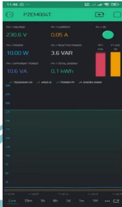
Gambar 4.2 Hasil pengukuran PZEM-004T Blynk
