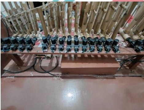
L-3 3 pemasangan motor ke angklung
