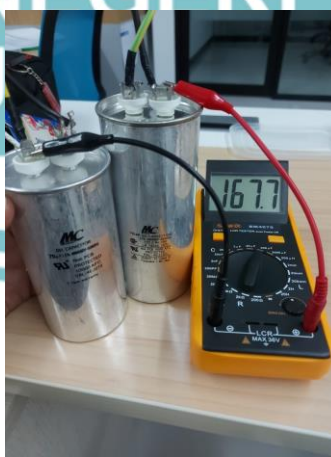
Merakit filter pasif LC untuk individual harmonik arus orde 5
